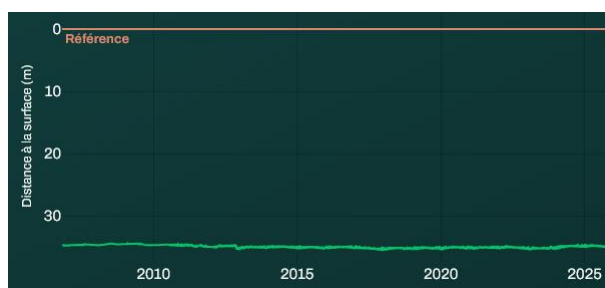
Figure 50: Niveau de la nappe à la station de Bay.
